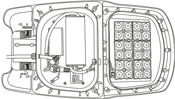
**ES** Fácil acceso a los componentes eléctricos con conectores rápidos que permiten hacer modificaciones o reparaciones de forma sencilla sin necesidad de desmontar la luminaria. Consultar manual de montaje de NTE para saber las herramientas necesarias.
